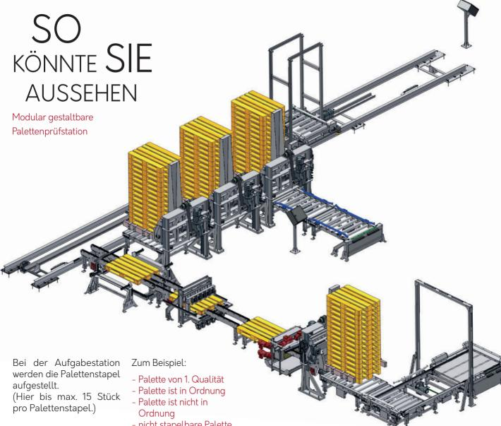
Die Paletten werden aus dem Palettenmagazin vereinzelt und anschließend jede seperat durch die Prüfstation gefahren.
